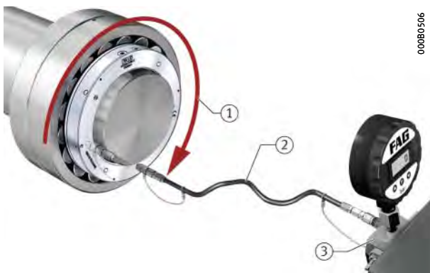
Figura 33 Arretramento del pistone anulare
