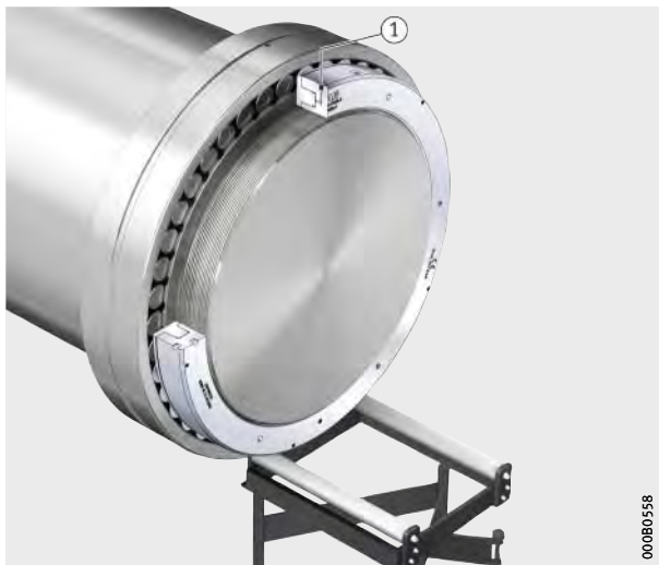
Figura 21 Leggero allentamento della ghiera idraulica
