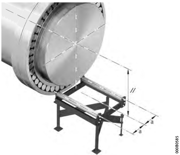
Figura 16 Allineamento dell'attrezzo di montaggio
